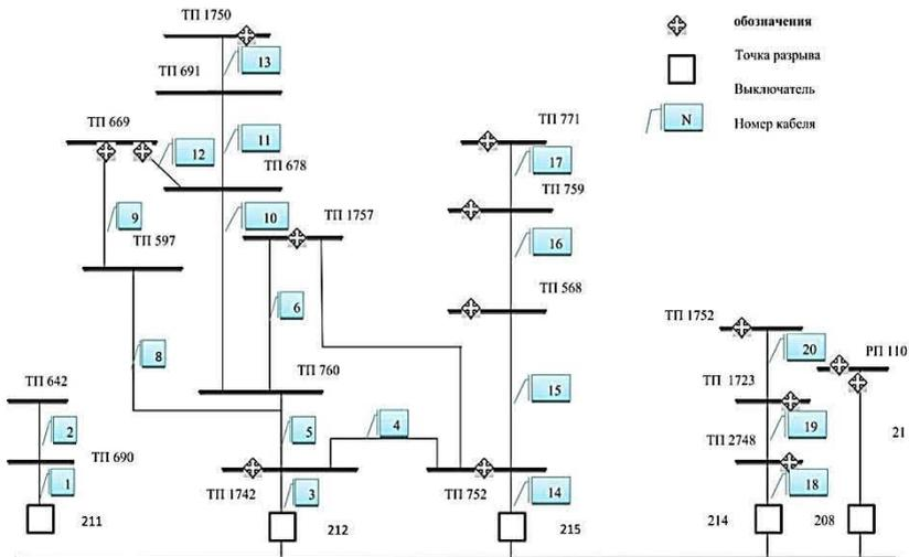
Рисунок 1 – Сборная секция шин подстанции «Рабочая»
