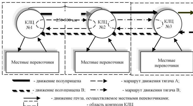
Рисунок 1 – Схема организации линейных перевозок на маршруте
