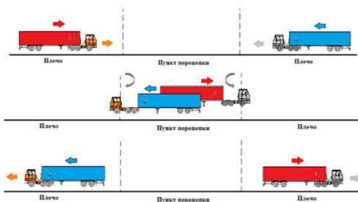
Рисунок 2 – Суть метода «тяговых плеч» с перецепкой полуприцепов
